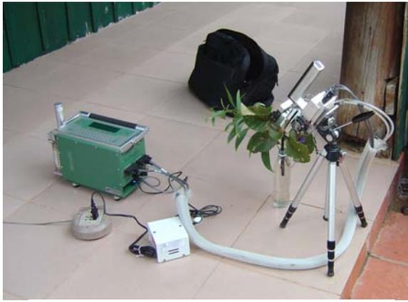
図 5. 個葉レベルの蒸散・光合成速度の測定
